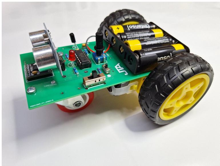
Das JTA Car ist mit einer Ultraschall Hinderniserkennung ausgestattet um Kollisionen zu verhindern.
