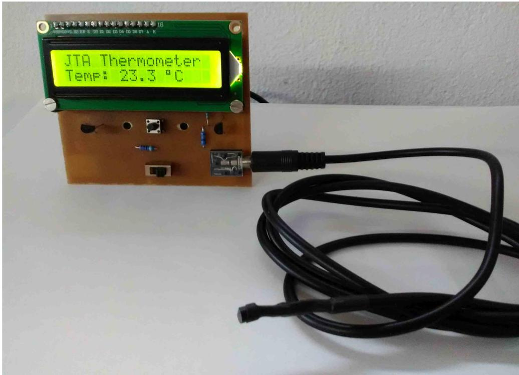
Das Thermometer wird durch kurzes Drücken der Taste eingeschaltet. Die Temperatur wird gemessen und für ca. 10 Sekunden angezeigt. Danach schaltet sich der Mikrocontroller aus, um Energie zu sparen. Erst nach erneutem Drücken wird die neue Temperatur wieder für ca. 10 Sekunden angezeigt.
