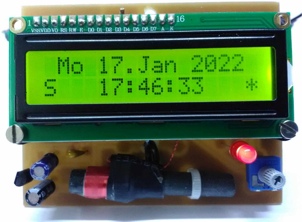
Die „JTA DCF77 Uhr“ empfängt die Zeit und Datumssignale einer Atomuhr. Diese Zeitsignale werden in Mainflingen bei Frankfurt am Main. auf 77,5 kHz ausgesendet. Die Gangabweichung der Atomuhr ist ca. 1s in 30 000 Jahren.
